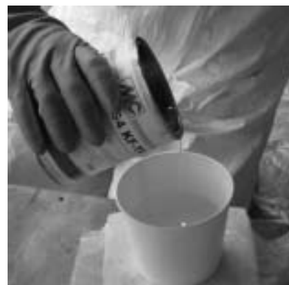
Abwiegen von Harz mit Schutzhandschuhen aus Nitril
