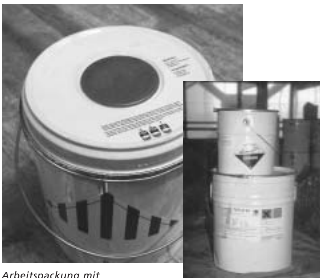
Arbeitspackung mit getrennten Gebinden für Harz und Härter
