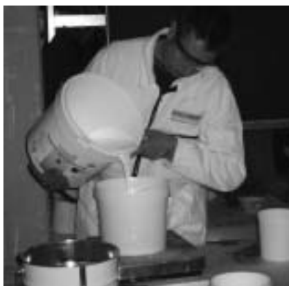
Richtige Schutzausrüstung beim Umgang mit Epoxidharzen
